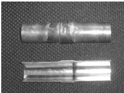
Foto: soldadura correctamente ejecutada con circulación de Nitrógeno, evitando oxidación.
